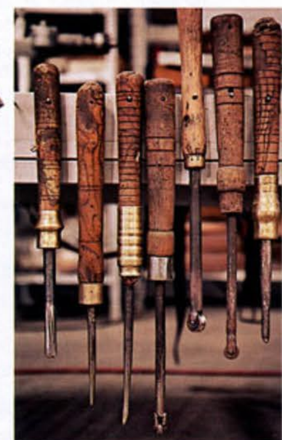
Estos buriles sirven para entallar las piezas. Las técnicas de trabajo siguen siendo las mismas que se empleaban en el siglo XIX.
