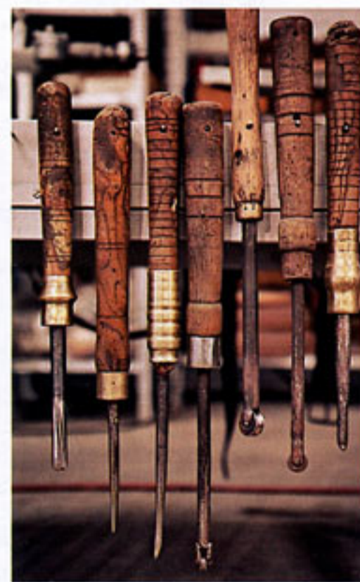
Estos buriles sirven para entallar las piezas. Las técnicas de trabajo siguen siendo las mismas que se empleaban en el siglo XIX.
